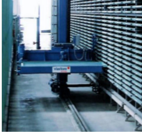
Figure 1.3: Machine de stockage et déstockage [17]
