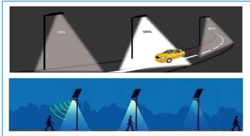
FIGURE 1.14: Contrôle de l'éclairage par détecteur de présence
