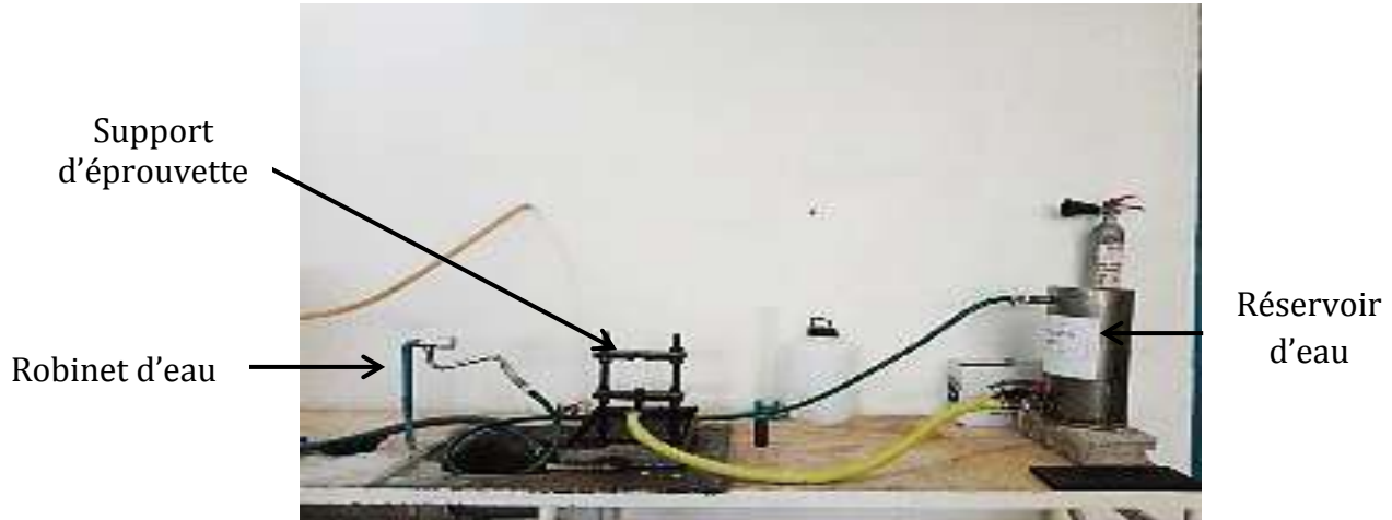
Figure 3 : Banc d'essai Jominy du laboratoire Science des matériaux (Université de Tlemcen - Faculté de Technologie)
