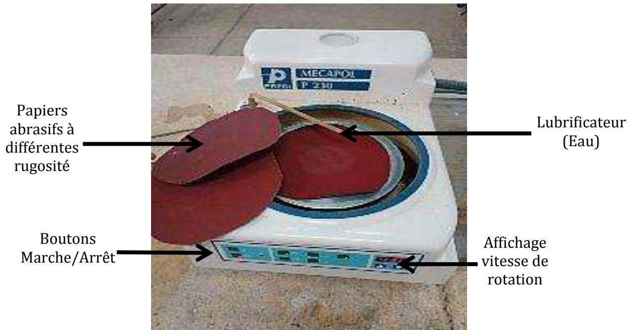
Figure 3 : Polisseuse du laboratoire Sciences des matériaux (Université de Tlemcen - Faculté de Technologie) - Algérie
