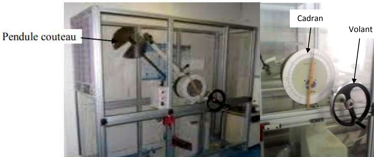
Figure 4 : Machine de résilience du laboratoire Sciences des matériaux (Université de Tlemcen - Faculté de Technologie)
