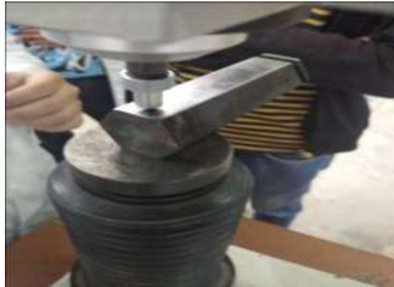
Figure 4 : Essai de dureté sur l'éprouvette JOMINY
