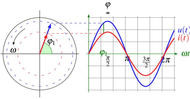
Figure 3: Représentation de Fresnel pour une résistance
