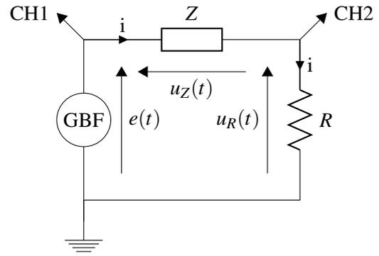
Figure 6: Circuit R.Z alimenter par un GBF et lié à un oscilloscope
