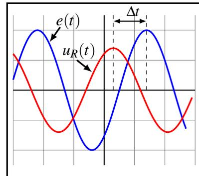
Figure 7: Les deux signaux  $e(t)$  et  $u_R(t)$  comme sur l'écran de l'oscilloscope.
