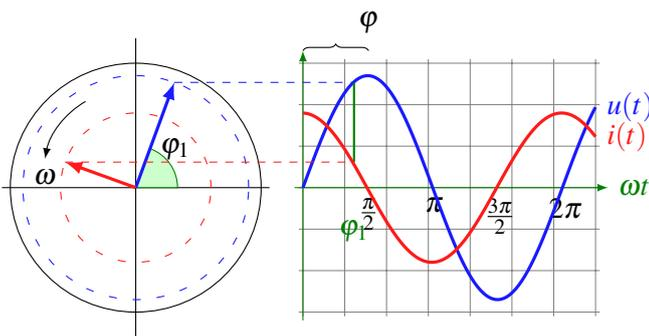
Figure 5: Représentation de Fresnel pour une bobine
