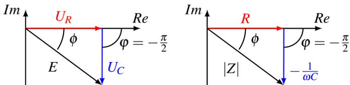
Figure 12: Représentation de Fresnel des tensions et impédances pour le circuit R.C.
