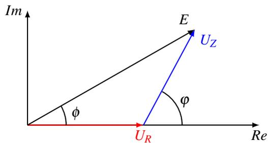
Figure 8: Représentation de Fresnel pour les tensions du circuit R.Z.
