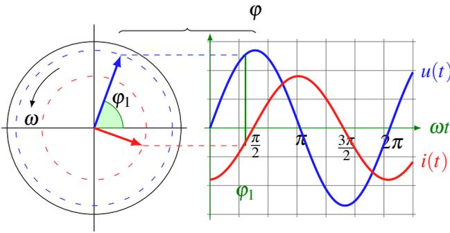
Figure 4: Représentation de Fresnel pour un condensateur
