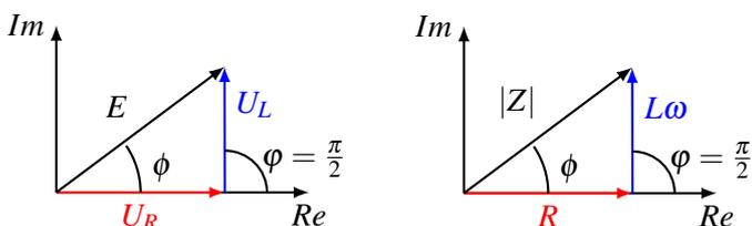
Figure 14: Représentation de Fresnel des tensions et impédances pour le circuit R.L.
