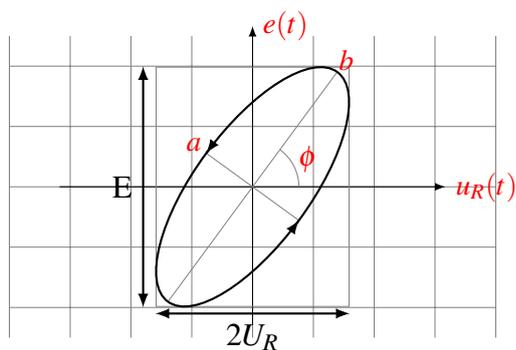
Figure 9: Figure de Lissajous des signaux  $e(t)$  et  $u_R(t)$ .
