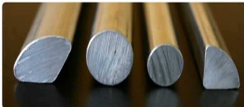
FIGURE 1.19 – Les conducteurs aluminium massifs ronds ou sectoriels
