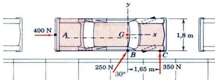
1. Déterminer le torseur résultant de ces actions au point G.
