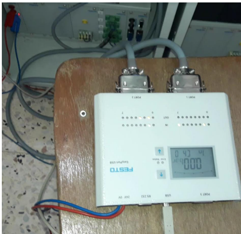
FIGURE 4.30 – Bronchement d'EasyPort USB avec l'ordinateur et station réelle
