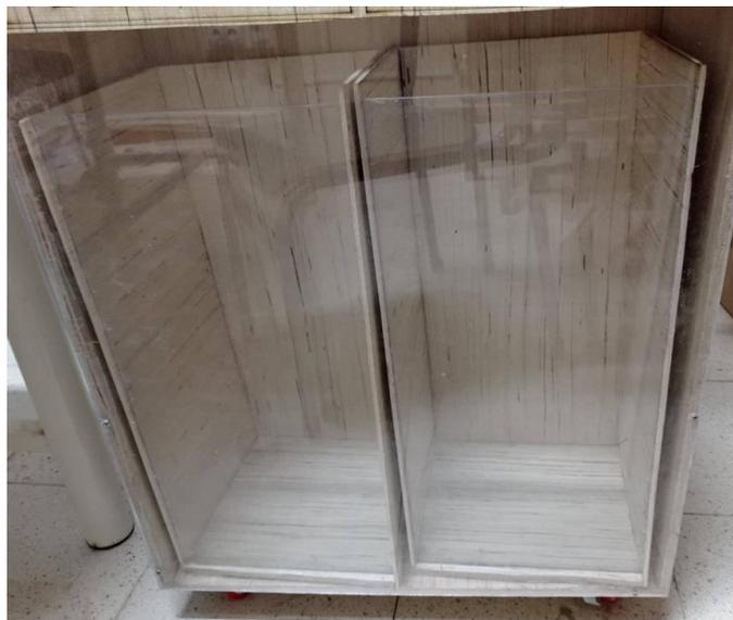
Figure 3.20 : L'assemblage de la partie inférieure
