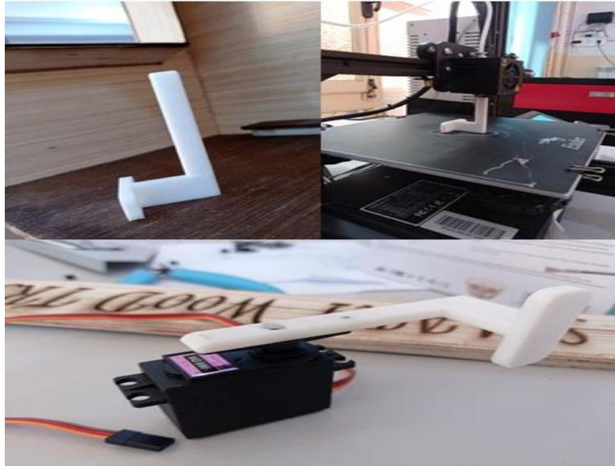
Figure 3.17 : Pièces moteur/ porte récompense
