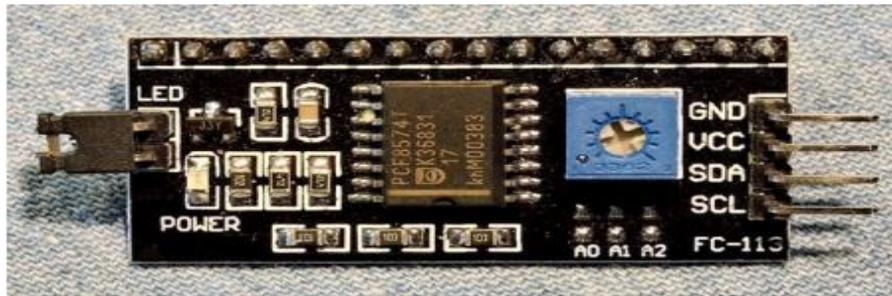
**Figure 2.12** : Le module d'interface série I2C
