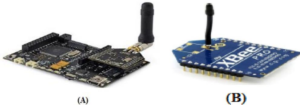
**Figure 1.7:** (A) : Carte de Waspote ; (B) : Module RF XBee-ZB-PRO
