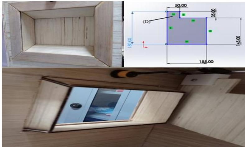
**Figure 3.6 :** Porte pour jeter les déchets: la partie pour la fixation de la porte avec l'arbre de rotation du moteur
