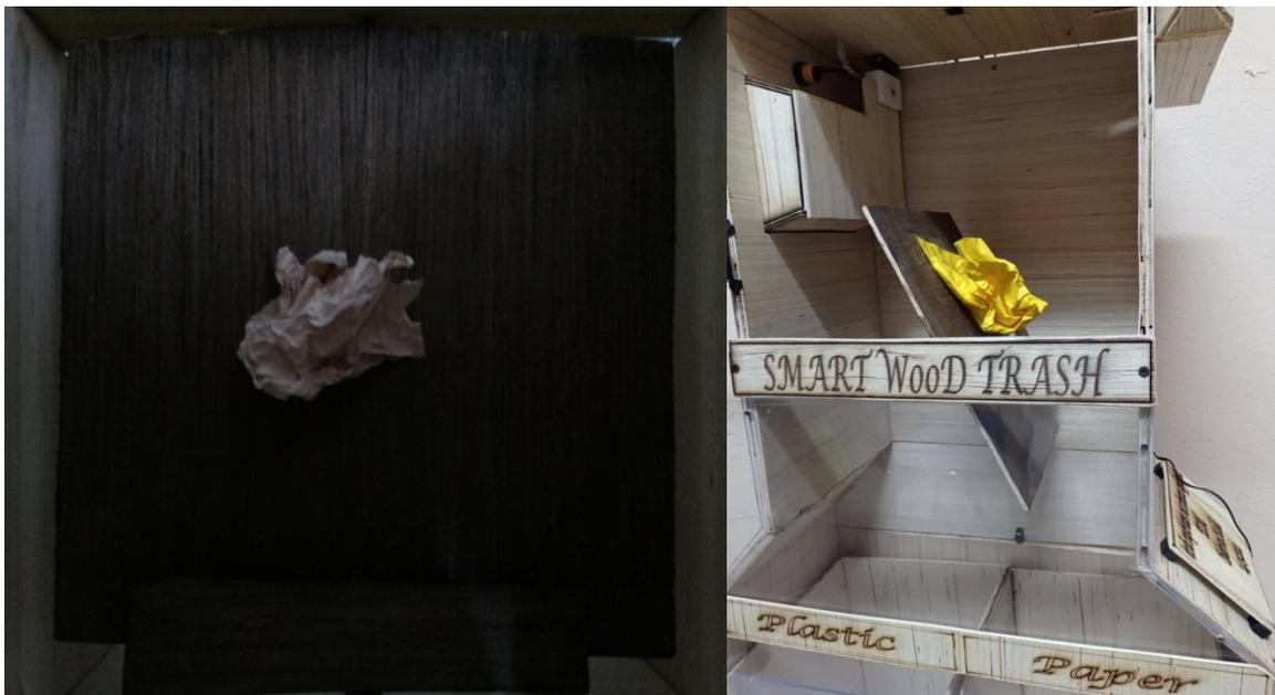
Figure 3.26 : Détection et l'acheminement du papier
