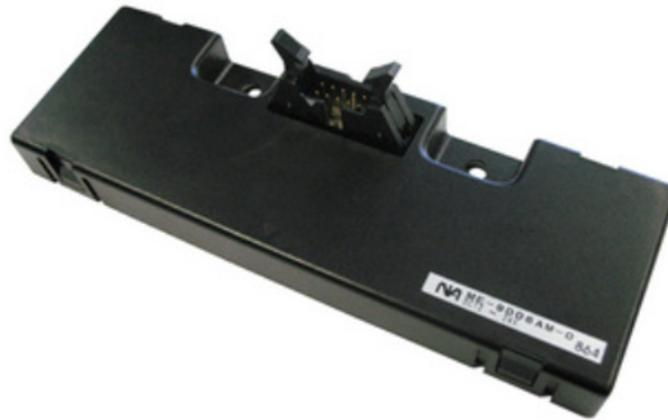
FIGURE 1.8: Capteur de guidage.
