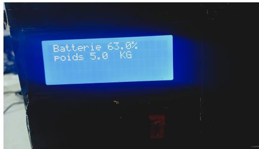
FIGURE 3.49: Affichage d'état de batterie et le poids
