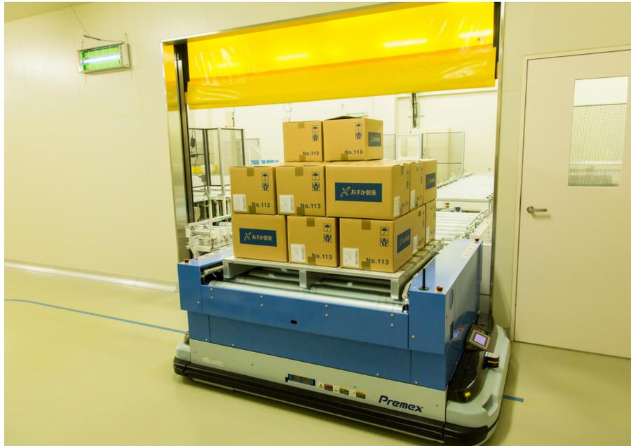
FIGURE 1.13: Unité de charge AGV par Muratec.
