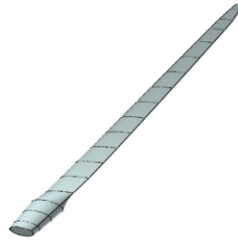
Figure : (IV.20) Pale de modèle HAWT en 3D pour le profil NACA4412
