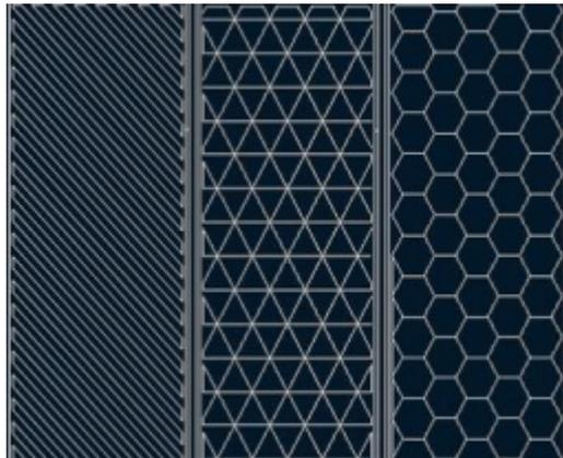
FIGURE 1.17 – Différents dépôts du thermoplastique : linéaire, triangulaire ou nid d'abeille [7]
