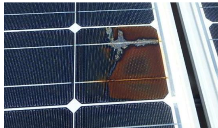
Figure 13 : Module affecté par la corrosion [8]
