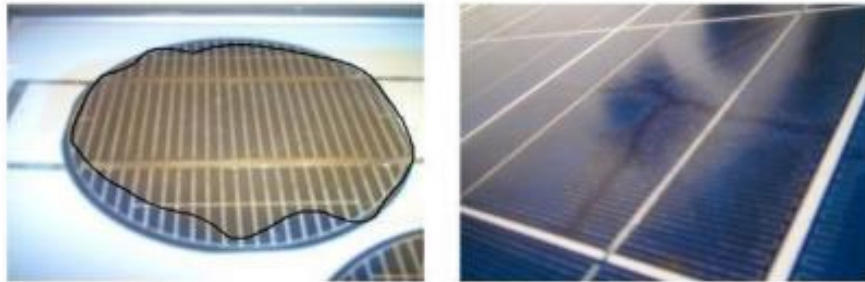
Figure I.15 : Module photovoltaïque avec des cellules décolorées [8]
