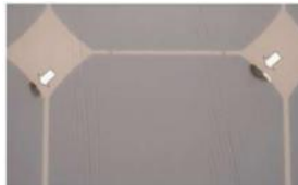
Figure I.17 : Modules présentant des points chauds sur les bords des coins supérieurs [5]
