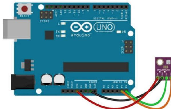
Figure III.16: Schéma de branchement du capteur de pression avec Arduino
