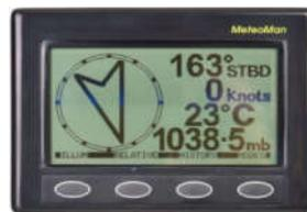
Figure I.8 baromètre électronique
