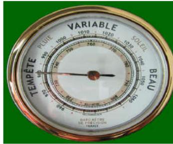
Figure I.7 Baromètre anéroïde
