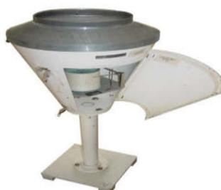
*Figure I.22 Pluviomètre À auget basculeur*
