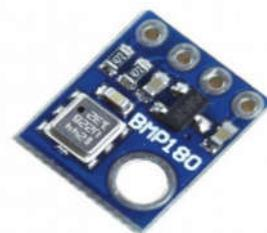
Figure II.13 Capteur de pression BMP 180
