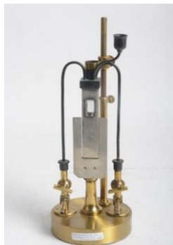
Figure I.16 Hygromètre à condensation
