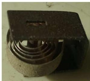
Figure I.13 Hygromètre à bobine métal-papier
