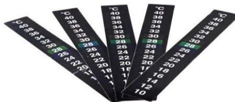
Figure I.3 Thermomètre à cristaux liquides
