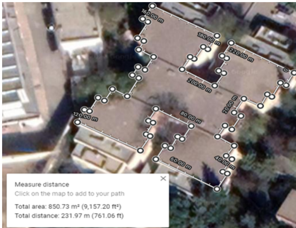
Figure III.4: Dimensions de surface du toit du bloc C
