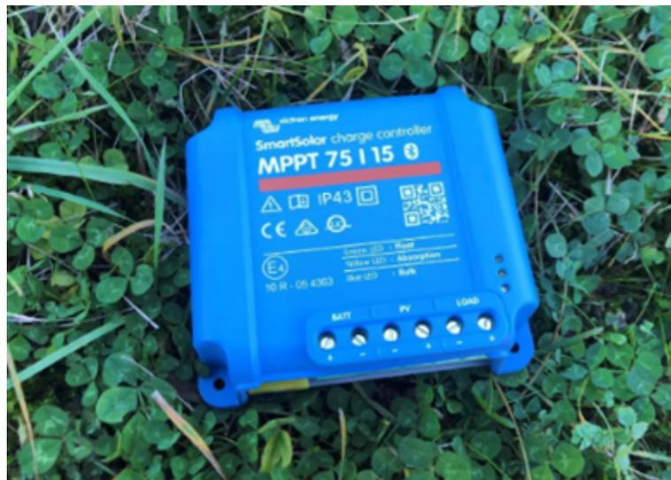
Figure II.19: Régulateur de charge
