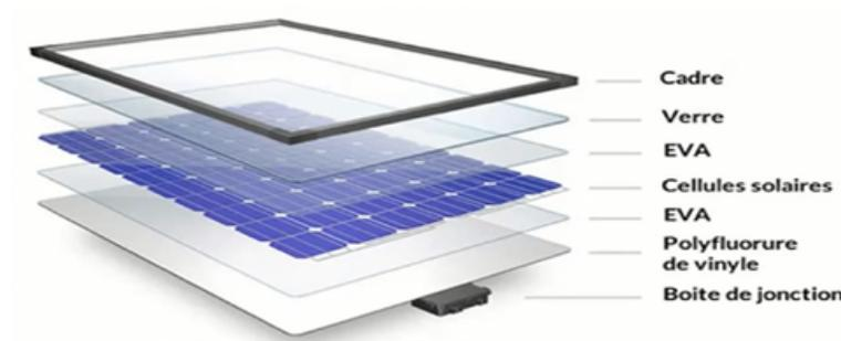
Figure II.5: Les différentes couches de panneau solaire
