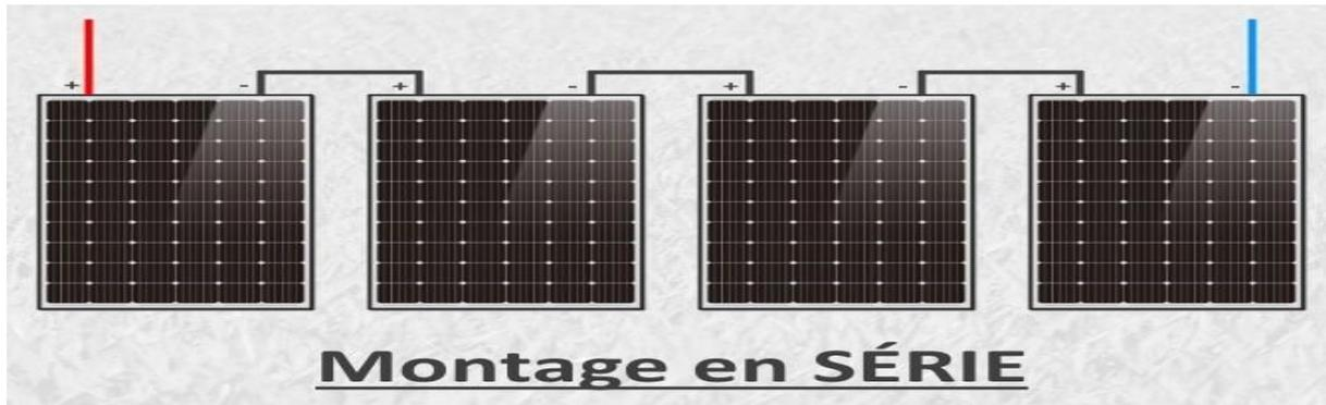
Figure II.10. Branchement en série des panneaux solaires.
