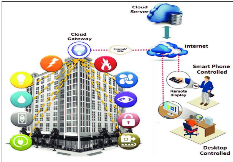
Figure III.5: Les commandes des bâtiments intelligents. [35]
