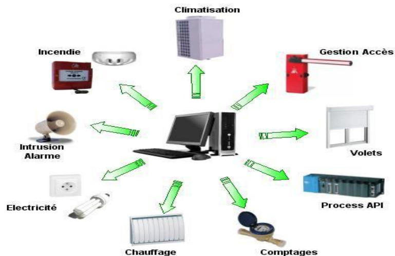
Figure I.9 : Gestion Technique Centralisée. [12]
