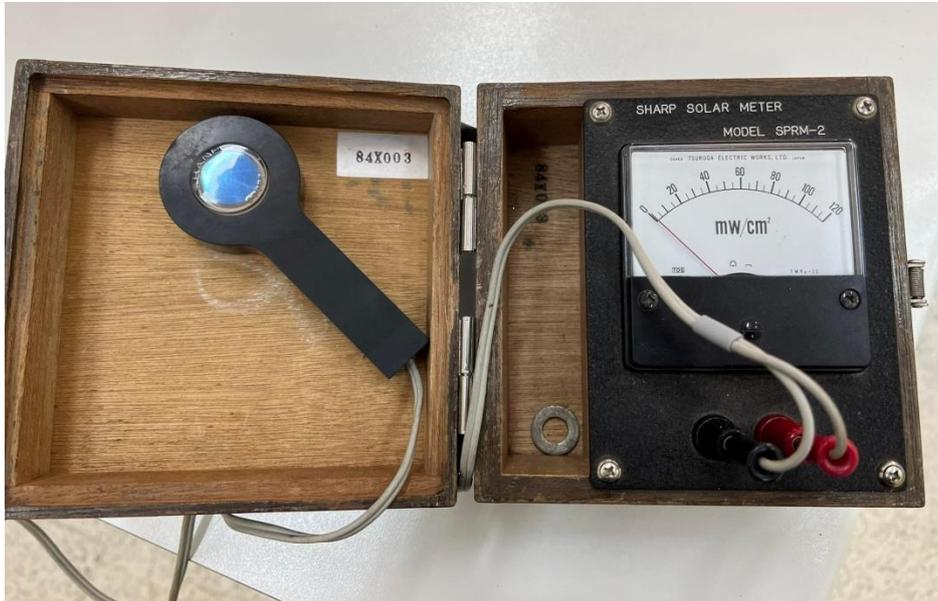
**Figure III-4 :** Photo réelle du solar Meter.
