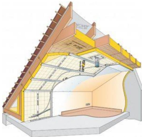
**Figure I-13 :** Principe d'isolation du toit par l'intérieur. [18]
