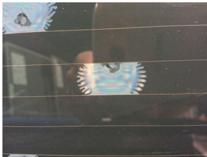
Fig 3.12 : Formation de shunts à points chauds au niveau de l'interconnexion des cellules associés à des dommages sur de grandes surfaces de cellules
