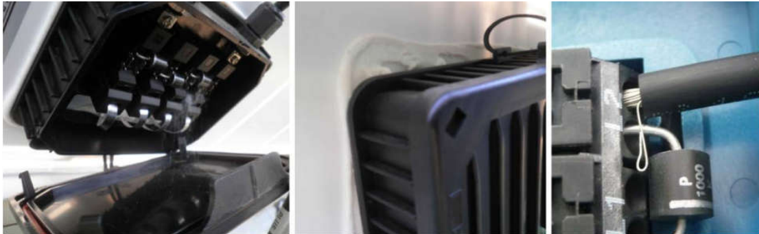
Fig 3.5 : Défaillances de la boîte de jonction.
