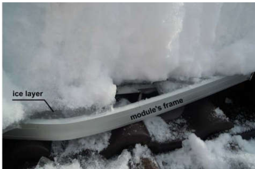
Fig 3.6 : Un coude de cadre entraîné par la neige.
