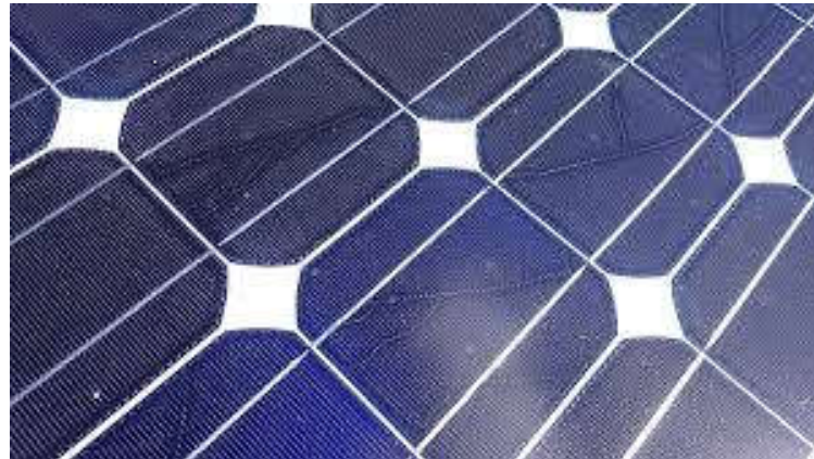
Fig 3.8 : photographie d'un module PV à piste d'escargot.
