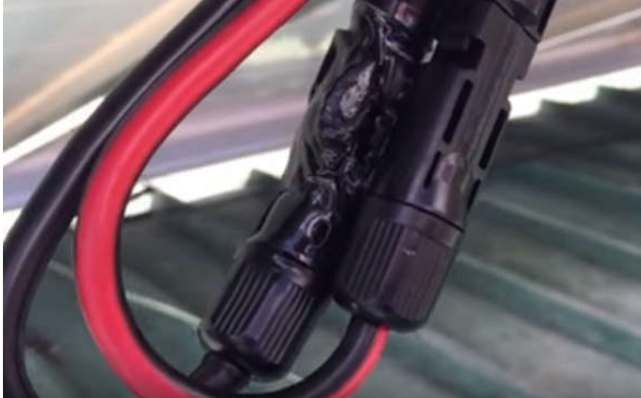
Fig 3.2 : Un cas réel de la défaillance du connecteur.
