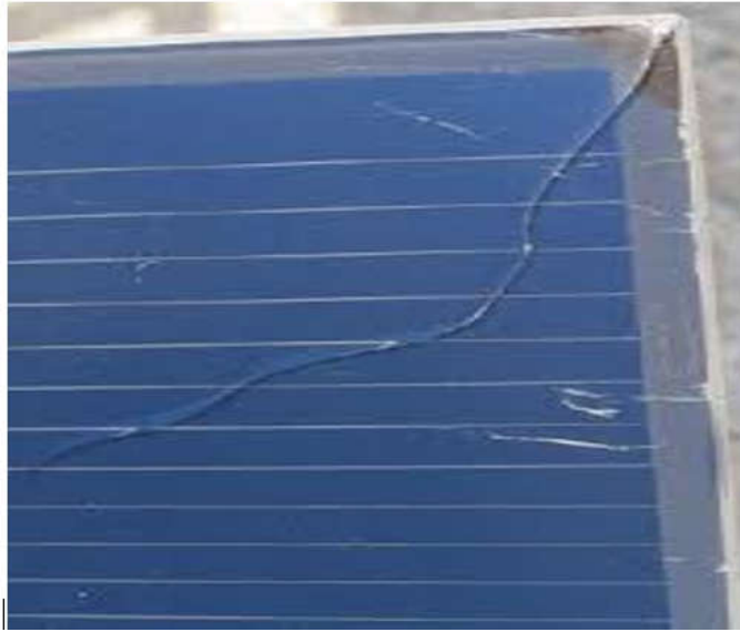
Fig 3.13 : Bris de verre à la façade pour un module CdTe.
