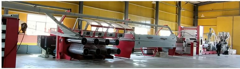
FIGURE 3.4: L'extrudeuse.
