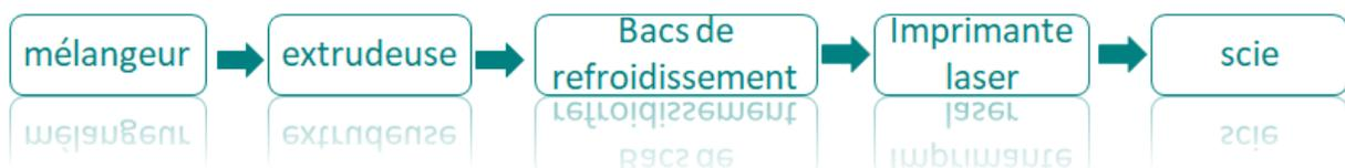
Figure 1.2 : processus de production des tubes PVC
