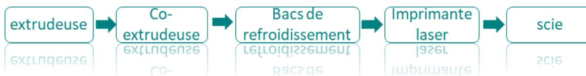
Figure 1.3 : processus de production des tubes PEHD
