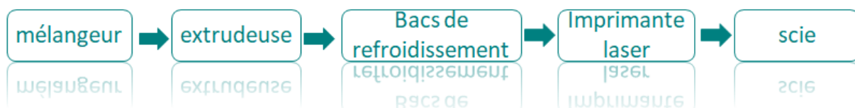
Figure 1.2 : processus de production des tubes PVC
