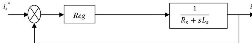
Figure (IV.4) : Boucle de régulation du courant.
