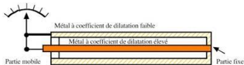
Figure 4 : Schéma descriptif d'un pyromètre linéaire.
