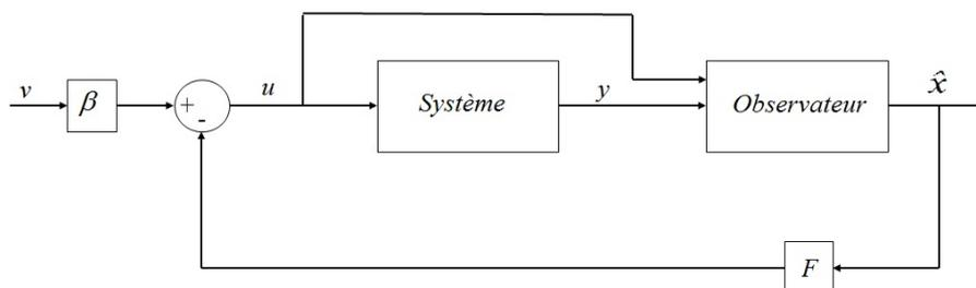
La synthèse d'un observateur ( estimateur d'état ou capteur virtuelle) consiste à trouver un modèle d'état pour l'observateur en se basant sur le modèle d'état du système.
