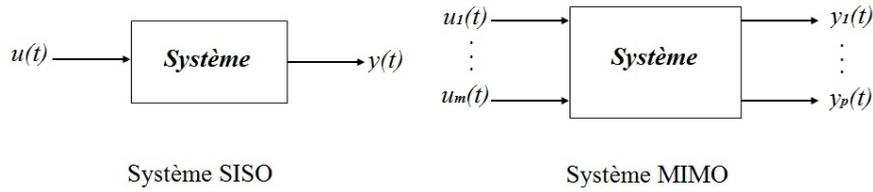
Les signaux d'entrée et de sortie sont alors représentés par des vecteurs notés respectivement  $u(t)$  et  $y(t)$  en temps continu et  $u_k$  et  $y_k$  en temps discret.
