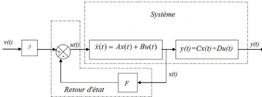
La commande par retour d'état consiste à déterminer une commande telle que les pôles du système en boucle fermée soient correctement placés dans le plan complexe. En effet, pour un gain  $F$  stabilisant le système en boucle fermée, le bouclage conduit au système :
