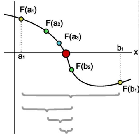
**Remarque 1** Cet algorithme réduit à chaque pas l'amplitude de la localisation d'un facteur 2. L'erreur est donc réduite d'un facteur 2 à chaque itération. En 20 itérations par exemple, l'erreur sera  $10^{-6}$  fois l'erreur initiale. Cette méthode est relativement lente. Par contre elle converge dans tous les cas où la fonction change de signe au voisinage de la racine. C'est une méthode que nous qualifierons tout-terrain, lente mais quasiment infaillible.
