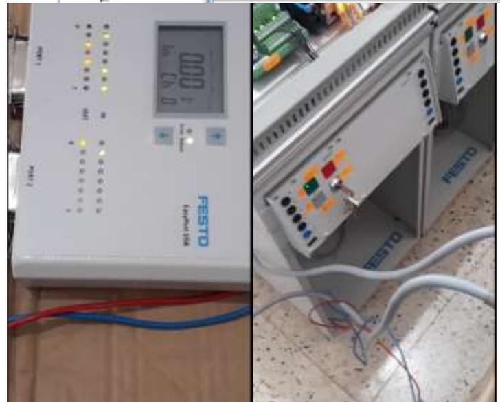
**Figure III.32:** Synchronisation de la visualisation entre EasyPort USB, STEP 7, PLC SIM et la Station réel
