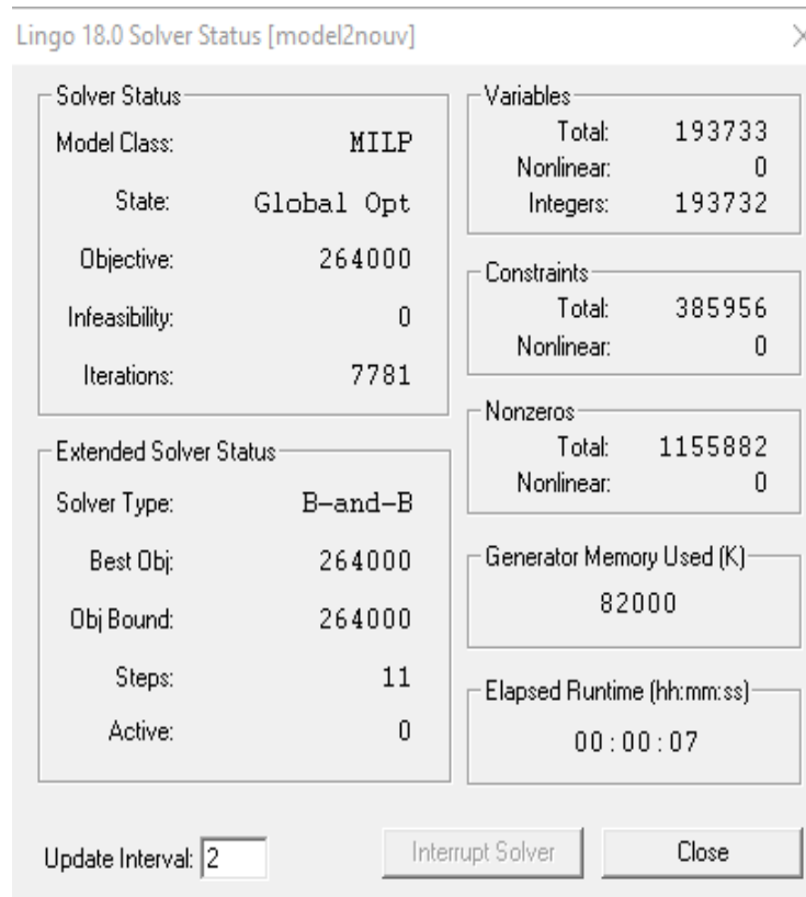
Figure III.16 : les résultats donnés par le solveur Lingo du 3 ème modèle (avec la nouvelle capacité des bacs qui égale à 630L).
