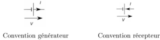
FIGURE 1.3 – Conventions générateur à droite, récepteur à droite
