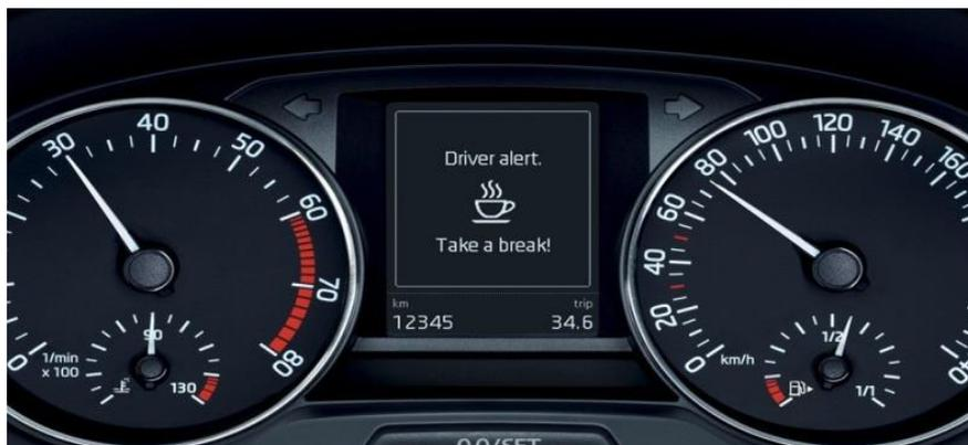
**Figure 1-6 :** L'alerte du système de détection de la fatigue de Volkswagen (Driver Alert) [46].
