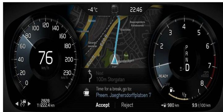
Figure 1-4 : Le système de détection de la fatigue de Volvo dans la voiture CX90 [43].
