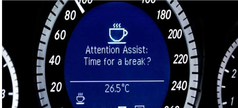
**Figure 1-5 :** L'alerte du système de détection de la fatigue de Mercedes-Benz (ATTENTION ASSIST) [45].
