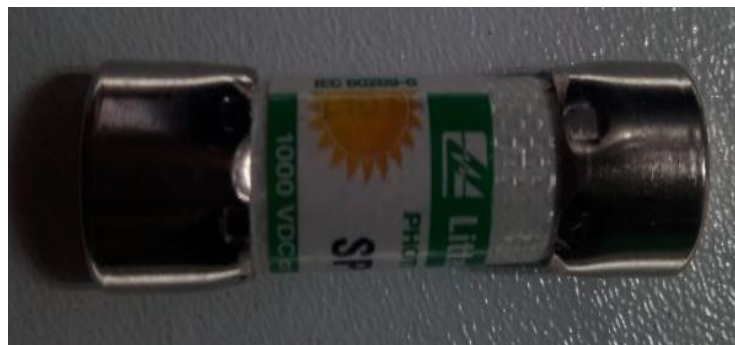
FIGURE IV-20 UN MODELE DE FUSIBLE UTILISE DANS CETTE CENTRALE.
