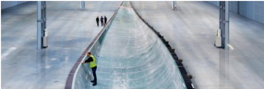
Figure 2.21 : Moule pour une pale éolienne Siemens en fibres de verre de 75 m [72].
