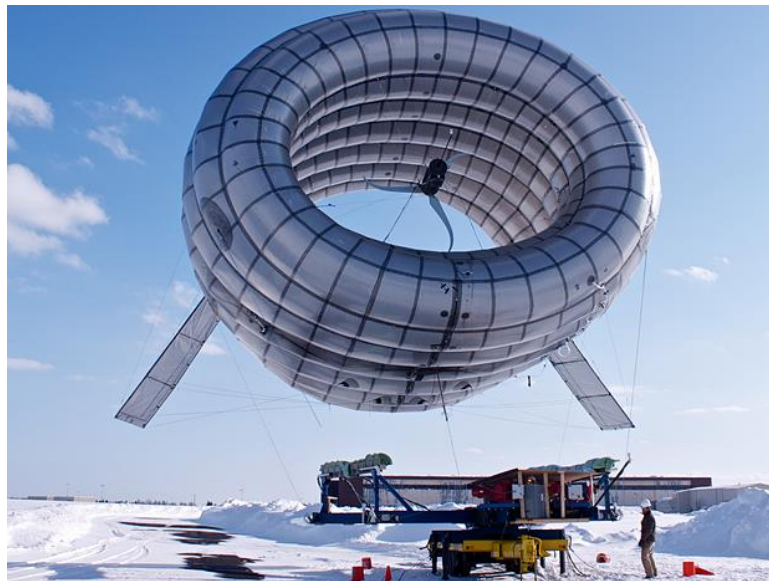
Figure 2.27 : Eolienne volante (Aéroportée) [78].
