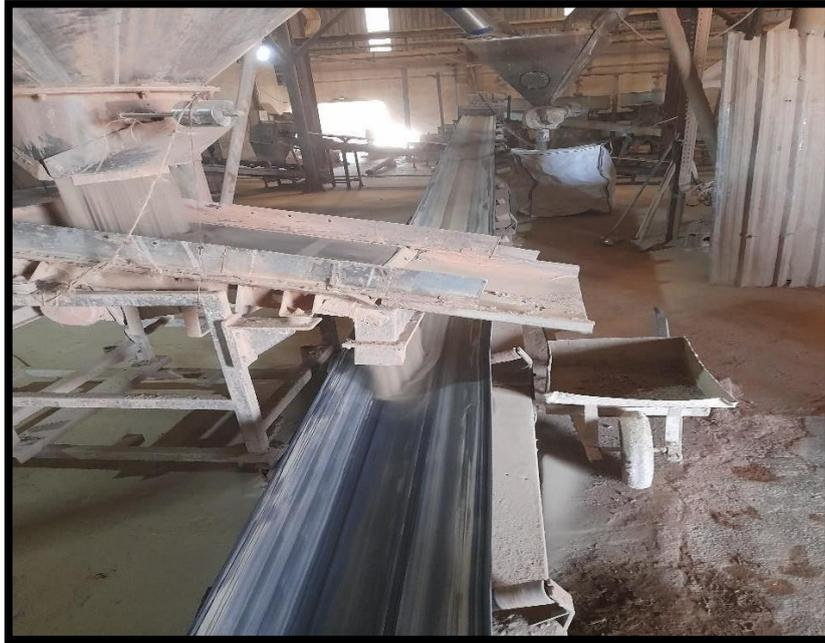
*Figure 21: Transfert vers les SILOS*
