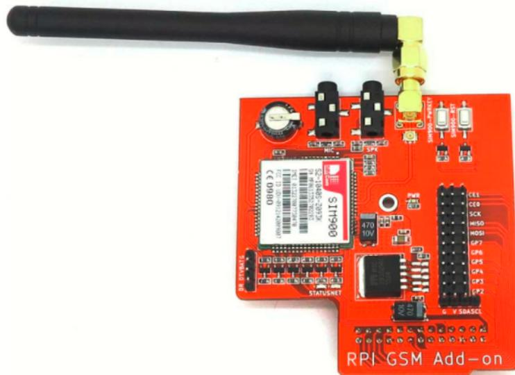
FIGURE 2.4 – Module GSM pour Raspberry pi
