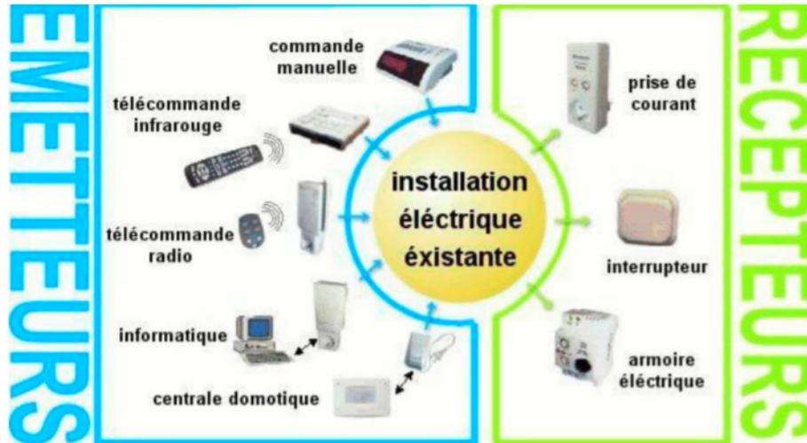
FIGURE 1.5 – Présentation de la technologie du courant porteur en ligne
