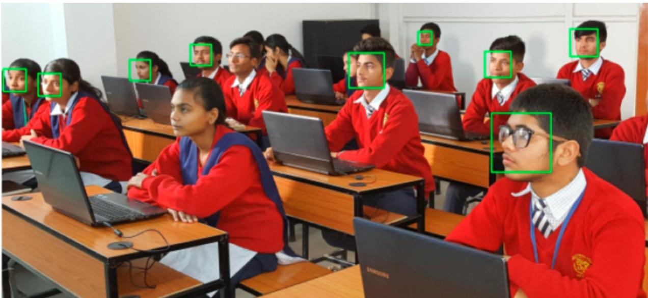
FIGURE 3.11 – Détection de visage utilisant Haar-cascade
