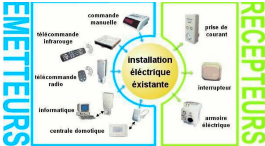
FIGURE 1.7 – Présentation de la technologie du courant porteur en ligne
