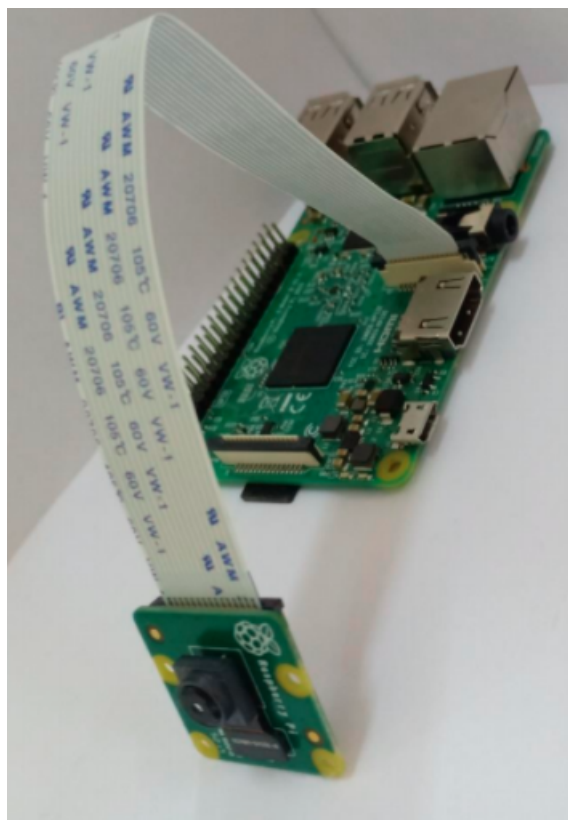
FIGURE 3.17 – Interfaçage du Raspberry pi avec le module caméra.
