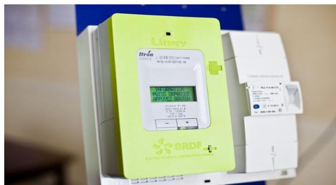
Figure III-3 Exemple d'un compteur intelligent « Smart metering » [9]
