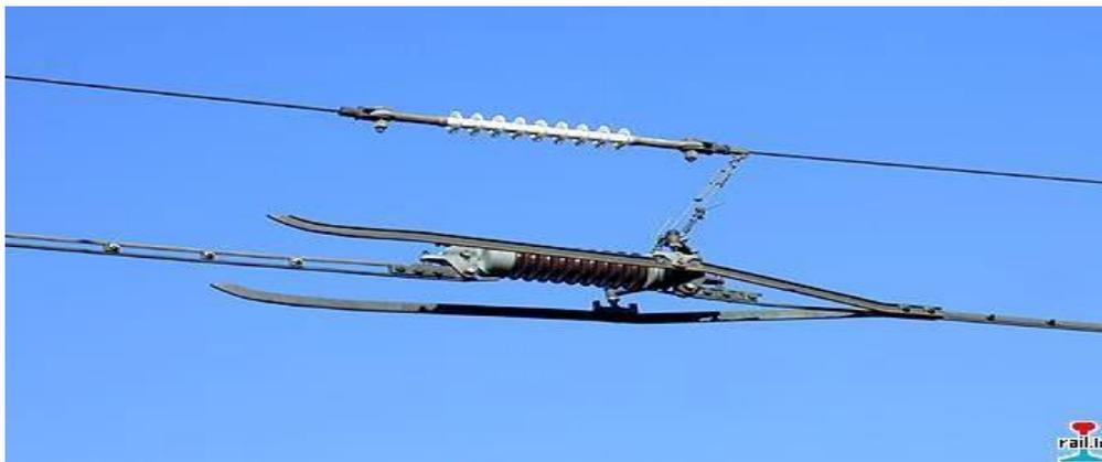
Figure I.5 : Section d'une LAC
