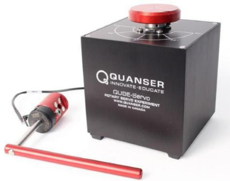
FIGURE 4.1: Maquette du pendule rotatif Quanser
