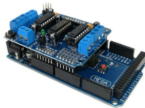
Figure 3.18: Connexion du Shield L293D avec Arduino
