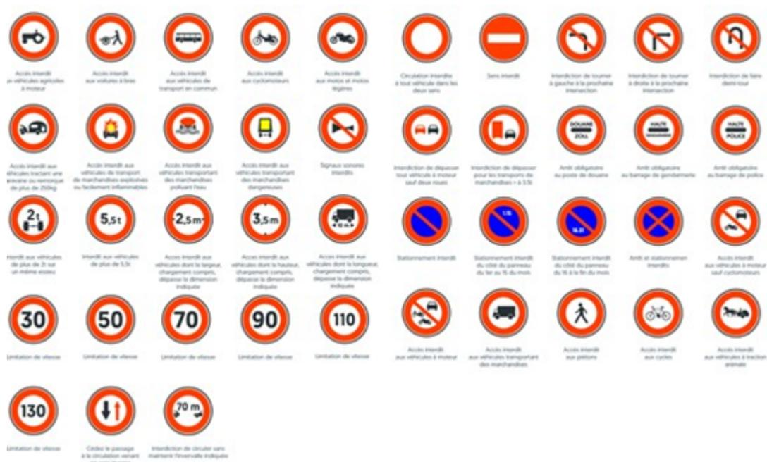
Figure 3.4: Signaux d'interdiction ou de restriction
