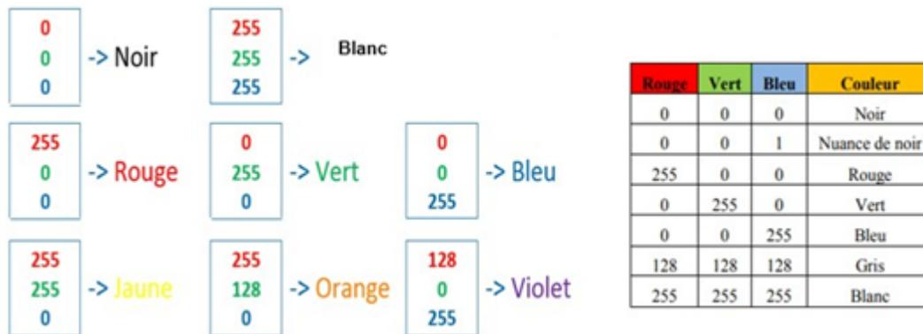
Figure 2.11: Principe codage de la couleur
