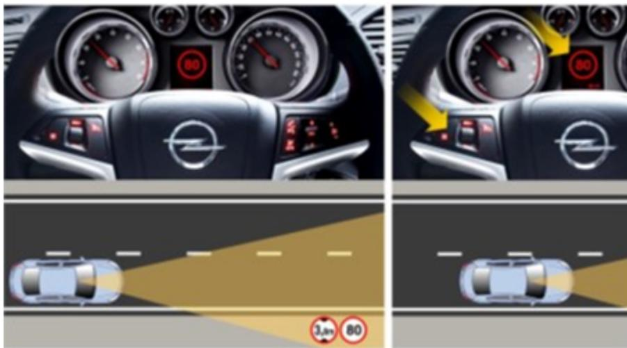
Figure 1.1: Exemple d'application RSR dans une voiture de la marque Opel
