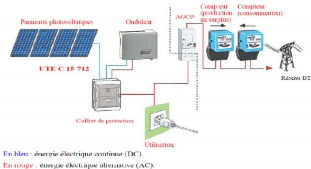
Figure 2.9: installation avec injection du surplus de la production photovoltaïque.
