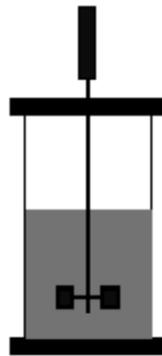
FIGURE 1.2 – Bioréacteur en mode d'alimentation discontinu [27]
