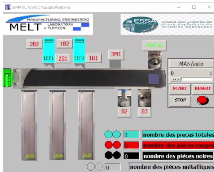
FIGURE 3.20 – Capteur détectant la présence de la pièce noire.
