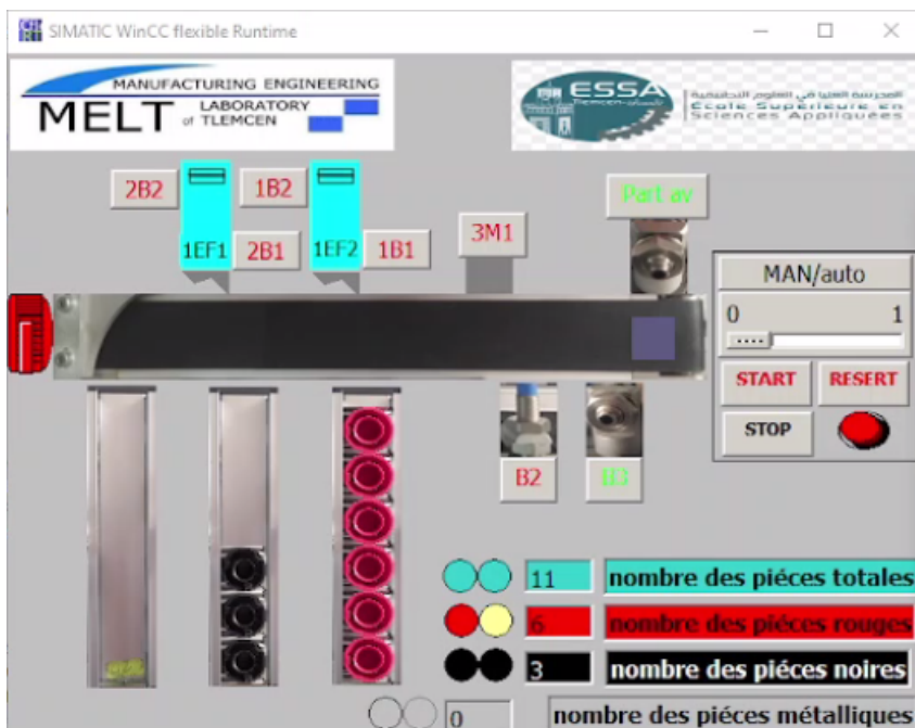
FIGURE 3.19 – Pièces rouges stockées dans un buffer spécifique.
