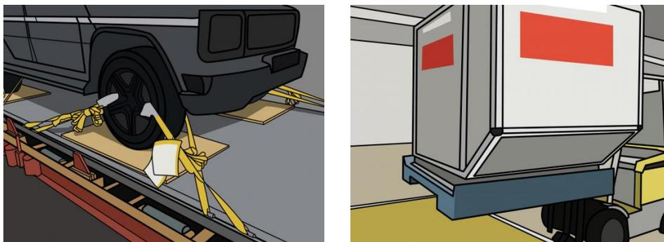
Figure II-15 Illustration de processus de sécurisation ULD
