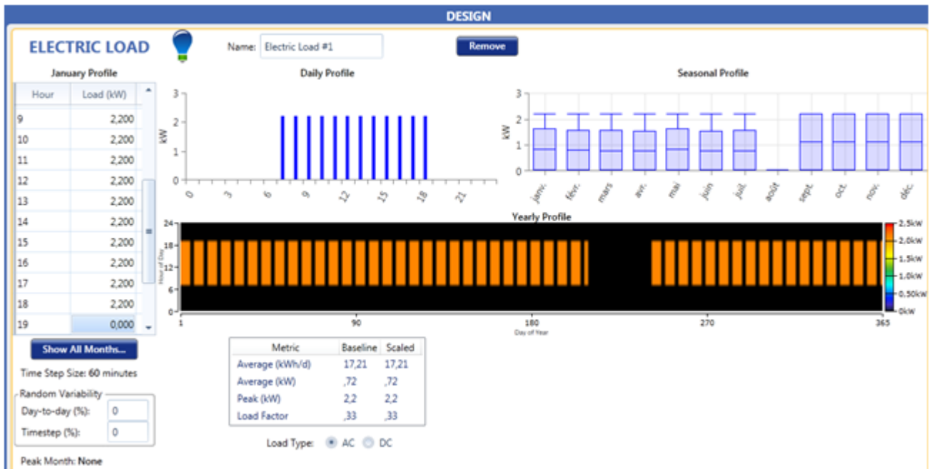
FIGURE 3.2: Profil de charge de notre cellule installé sur le site ESSA Tlemcen.
