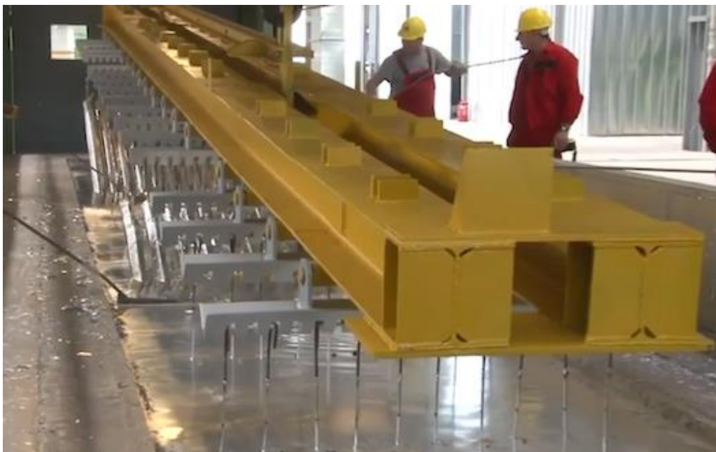
Fig.I.9 : Le bain de zinc fondu à 450 °C.
