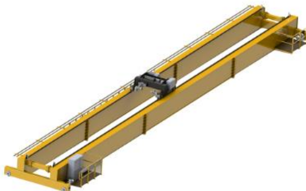
Fig.I.13 : Pont roulant bipoutre de l'usine.
