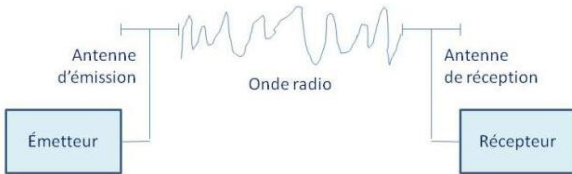
Fig.III.7 : Principe d'émission – réception.
