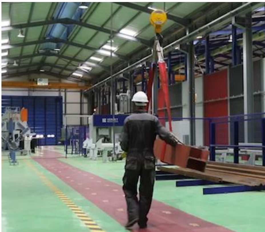
Fig.I.16 : Pont roulant bipoutre en mode charge commander et suivi par l'ouvrier.
