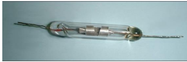
Fig.III.1 : Cohéreur. Tube à limaille.
