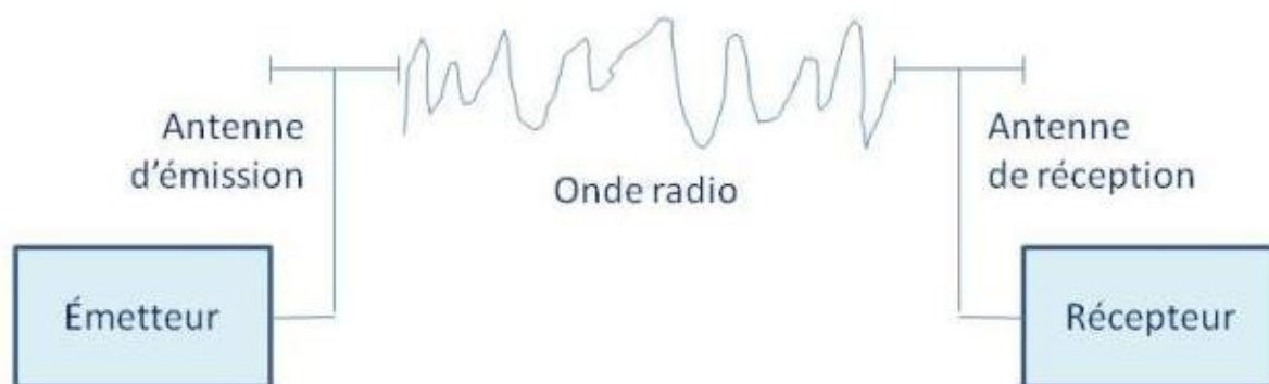
Fig.IV.I.14 Principe d'émission – réception.
