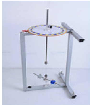
Figure 2.5: Pendule de torsion (a) Schéma d'un pendule de torsion (b)Photo du pendule de torsion
