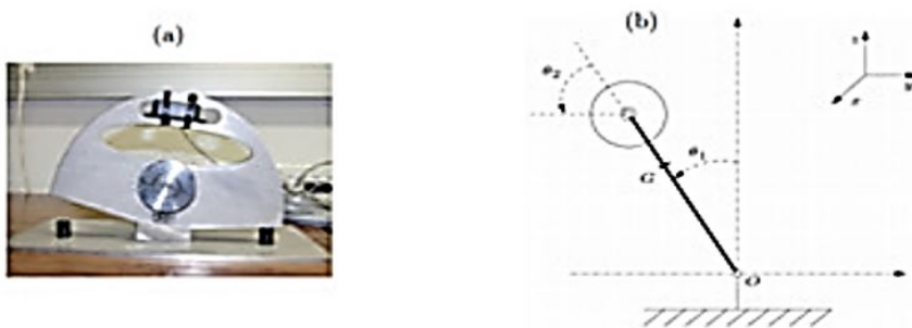
Figure 2.10: Pendule inversé stabilisé par volant d'inertie, (a) Photo du pendule (b) Schéma explicatif
