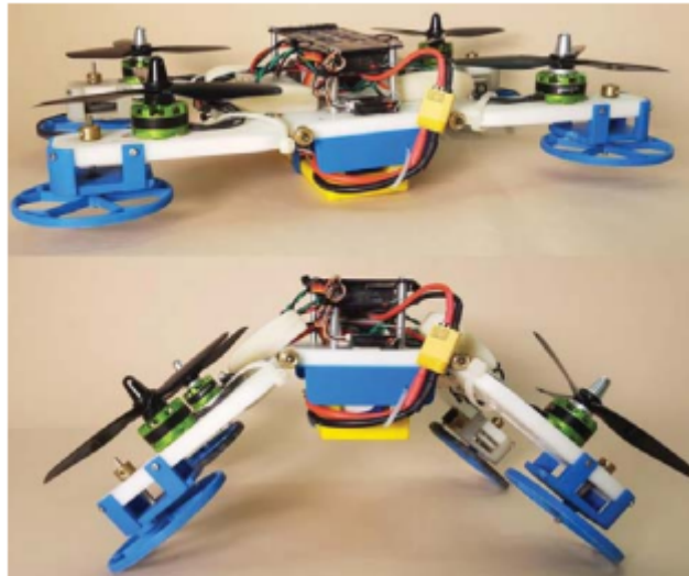
FIGURE 1.16: FSTAR est un robot nouvellement développé qui peut s'étendre sur ses jambes et en bas.
