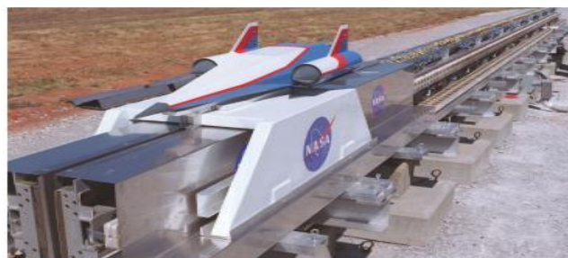
Figure I.11 : Piste de lévitation magnétique
